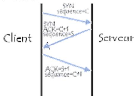
Lorsqu'un client établit une connexion à un serveur, le client envoie une requête SYN, le serveur répond alors par un paquet SYN/ACK et enfin le client valide la connexion par un paquet ACK (*acknowledgement*, qui signifie *accord* ou *remerciement*).
